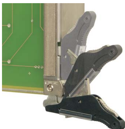
Poignée AdvancedTCA IEA, ressort de maintien en position ouverte
